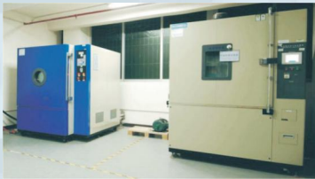
低气压测试箱 (左), 恒温恒湿测试箱 (右)
