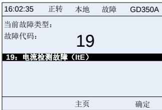
图 5-7 故障告警显示状态
